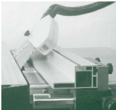
Fig. 33: Cut the beveled edge
